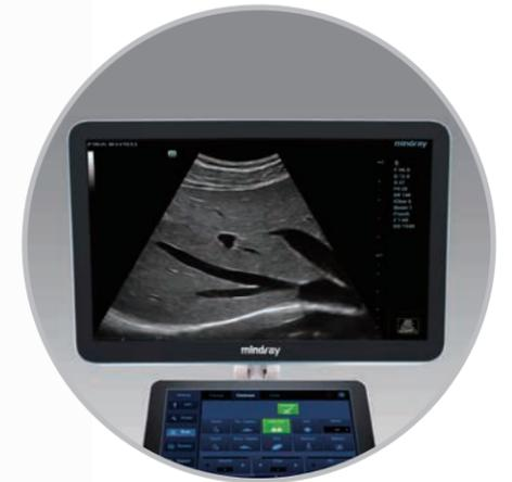
Monitor LED ad alta risoluzione con ampio angolo di campo
